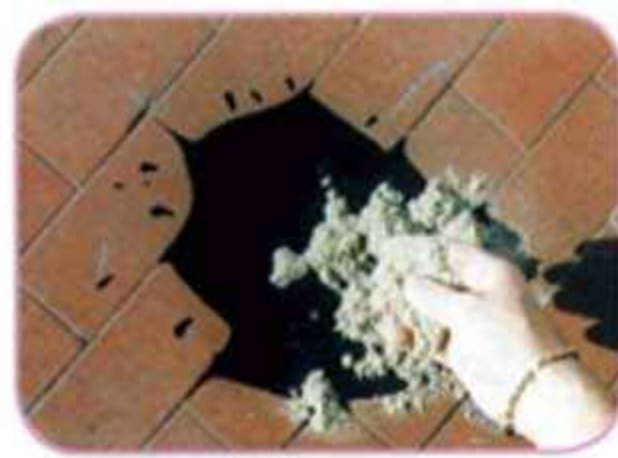
Prova di assorbimento con polvere di OKO PUR in acqua contaminata da olio.
