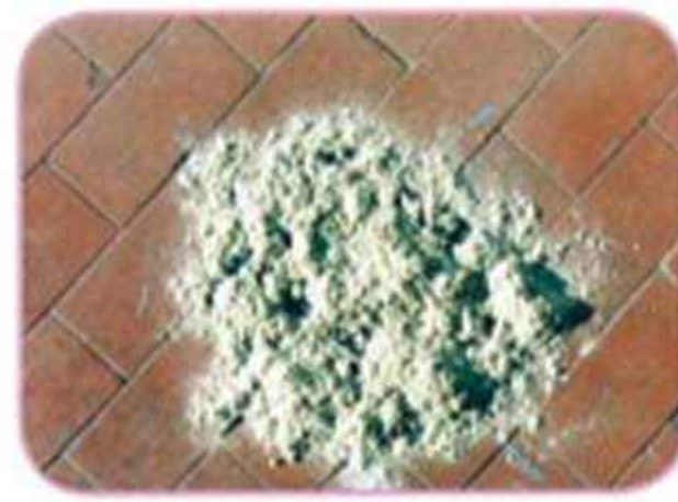
Prova di assorbimento con polvere di OKO PUR in acqua contaminata da olio.
